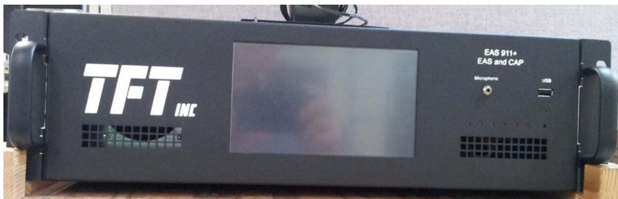
Figure 2.3-1. 911+ EAS-CAP Front Panel
